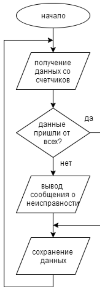
Рисунок 4 – Алгоритм работы в штатном режиме получения данных системой
