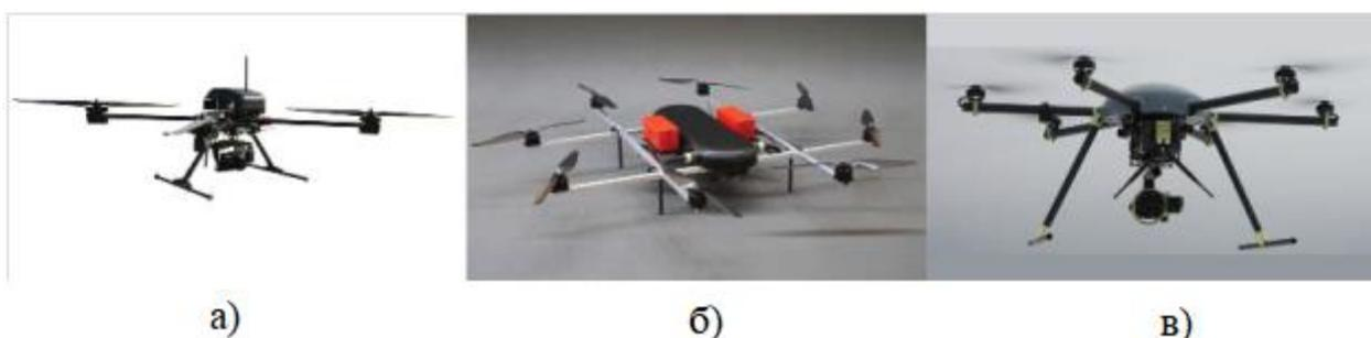
Рисунок 7 – БПЛА мультироторного типа, используемые в России для диагностики ЛЭП: а) Геоскан 401; б) Суперкам X8; в) Форпост X6.
