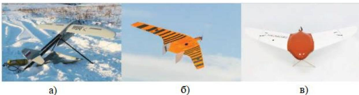
Рисунок 6 – БПЛА самолетного типа, используемые в России для диагностики ЛЭП: а) Птеро G0; б) Суперкам 350F; в) Геоскан 201
