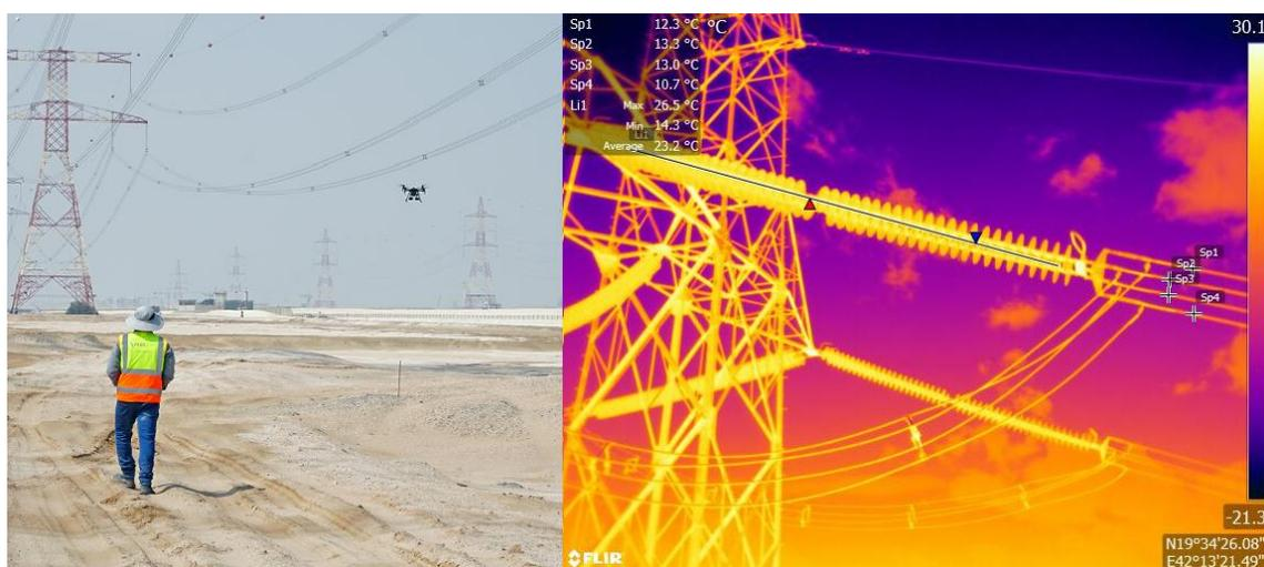
Рисунок 9 – Снимок с тепловизора БПЛА
