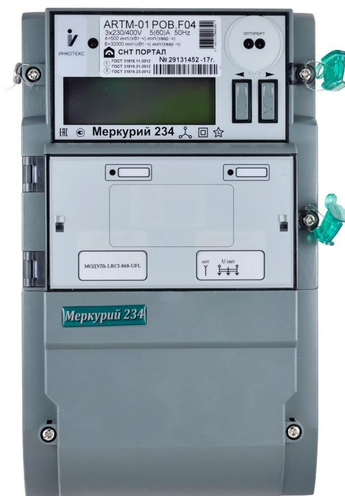
Рисунок 6 – Конструктивное выполнение и основной функционал современного микропроцессорного счётчика отечественного производства марки «Меркурий 234 ARTM F04 Лартех»
