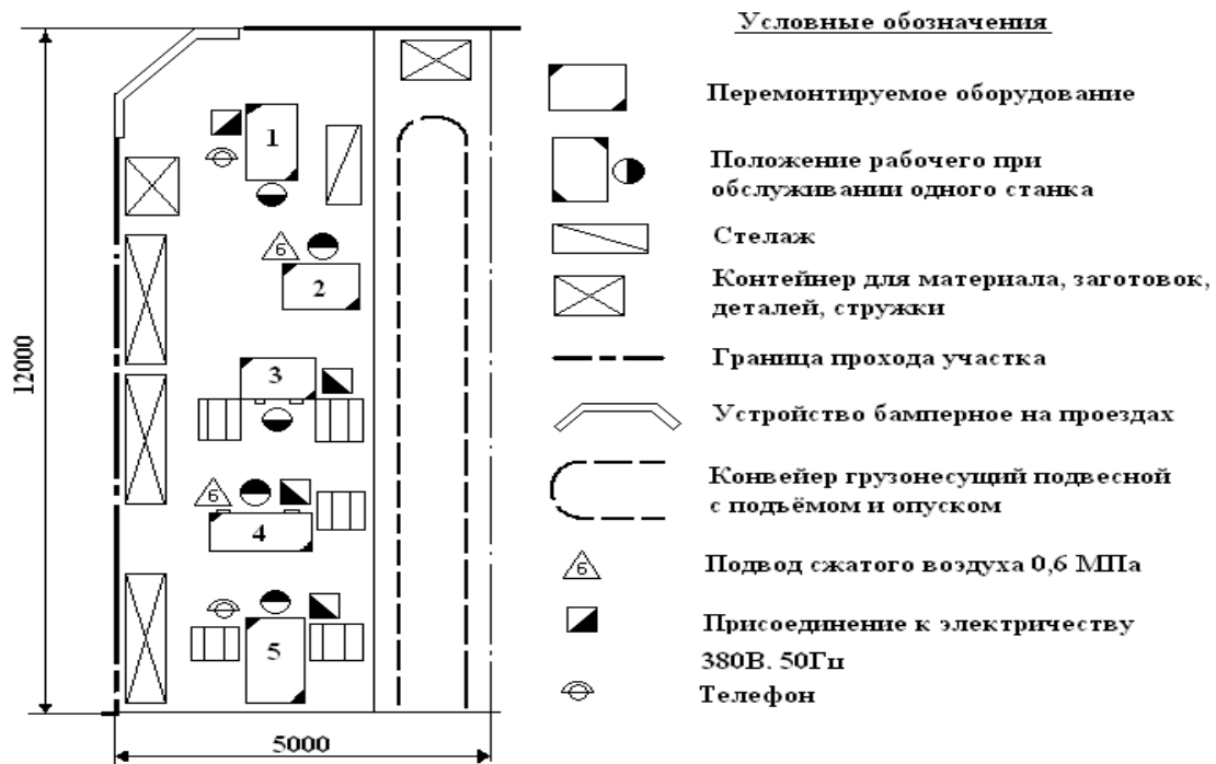
«Рисунок 5 - Эскиз рабочего места на участке сборки коробки передач
