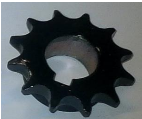
Рисунок 24 – Звездочка для привода цепной передачи
