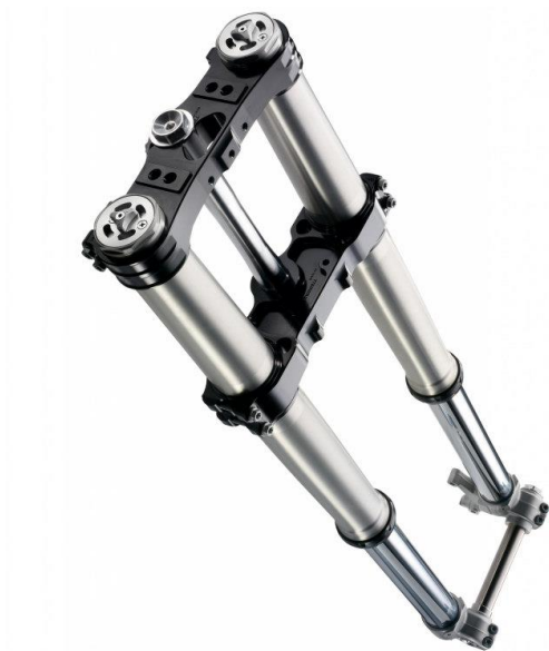
Рисунок 19 – Конструкция телескопической вилки
