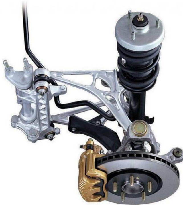
Рисунок 8 – Двухрычажная независимая подвеска
