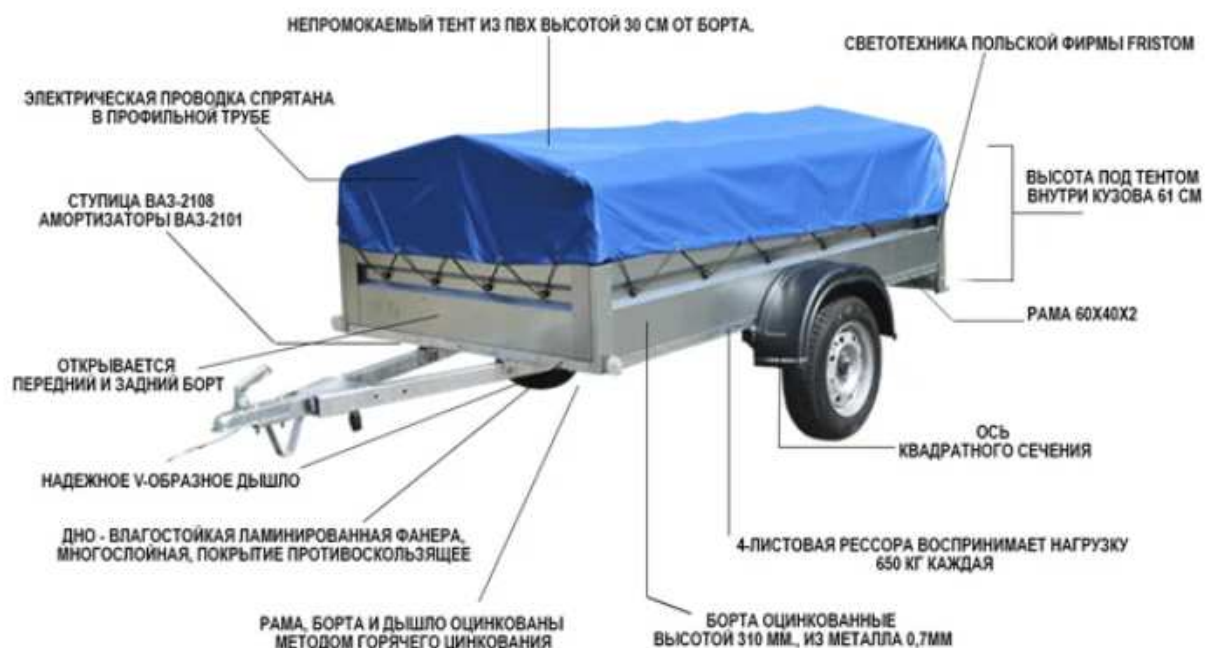
Рисунок 1 – Общая конструктивная схема бортовых прицепов
