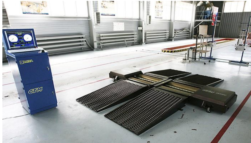
Рисунок 6 – Испытательный стенд СНТ-2.0
