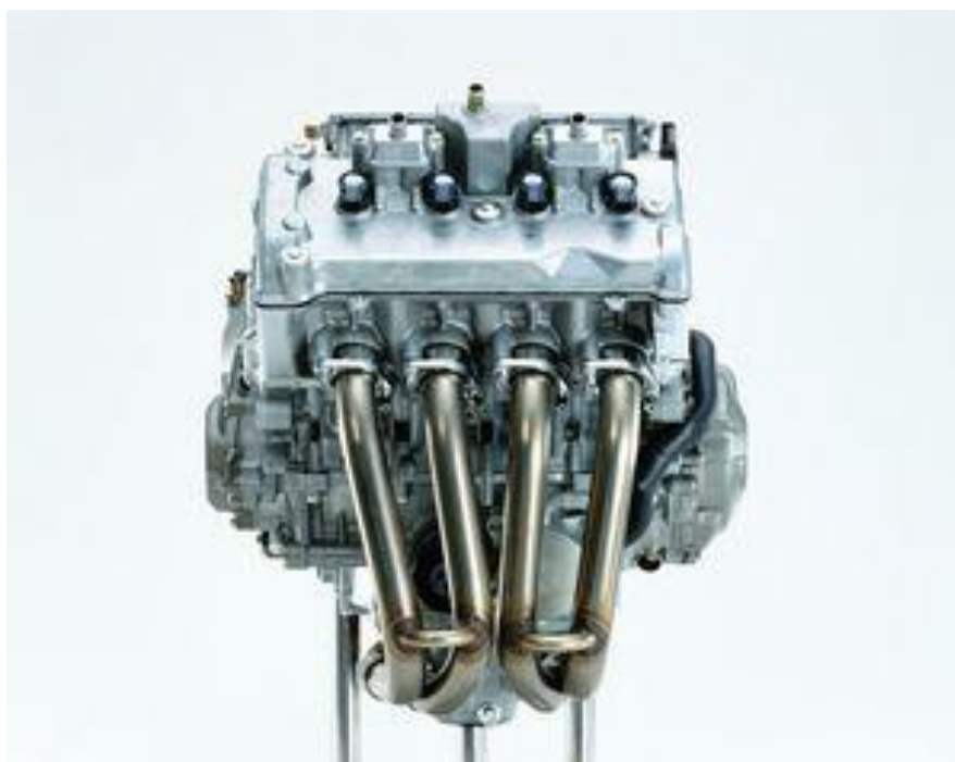
Рисунок 23 – Выпускной коллектор двигателя Honda CBR 600 RR. Вид спереди [20] 49
