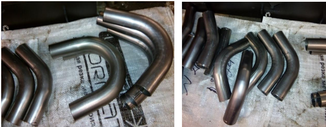
Рисунок Д2– Изготовленные участки труб
