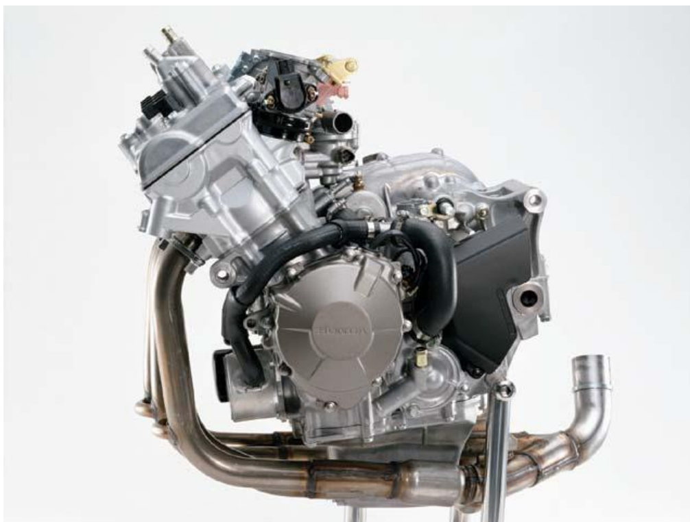
Рисунок 22 – Выпускной коллектор двигателя Honda CBR 600 RR. Вид сбоку [16]
