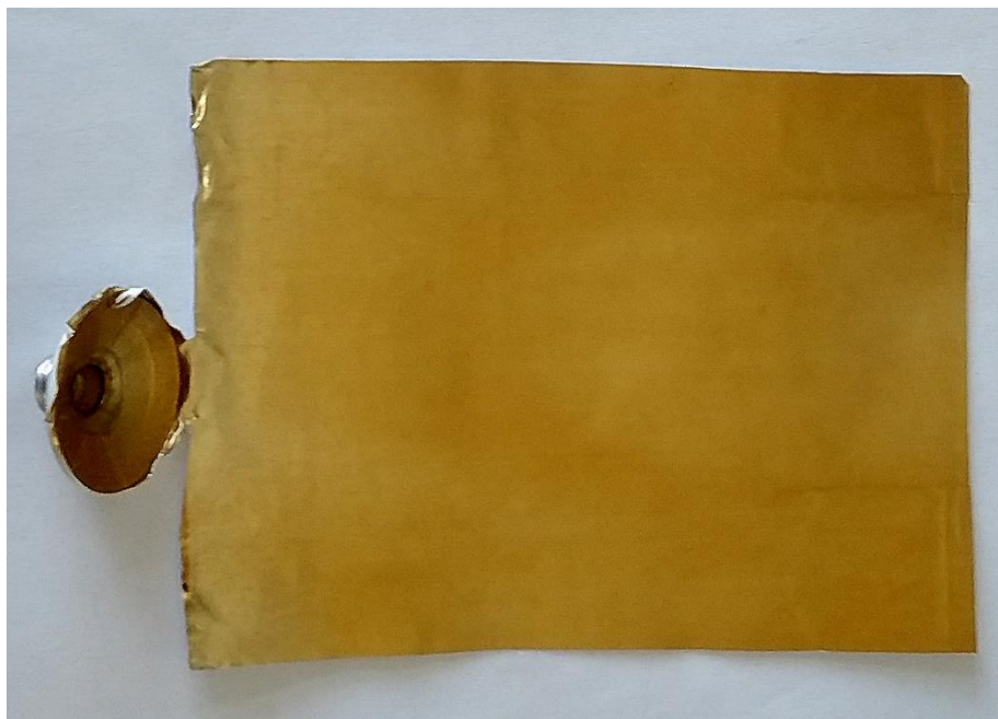
Рисунок 21 – Тубы с внутренним защитным покрытием на основе лака Valspar в разрезе
