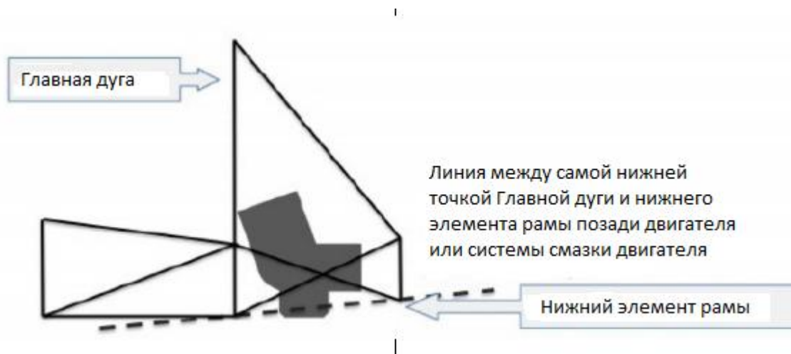
Рисунок 5.10 – Расположение поддона картера двигателя относительно габаритов рамы гоночного болида.
