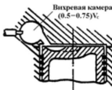
Рисунок 1.6 – Вихревая камера
