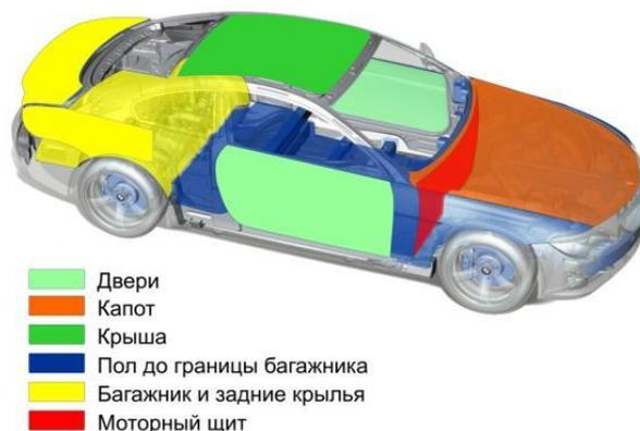
Рисунок 6.2 - Схема звукоизоляции автомобиля
