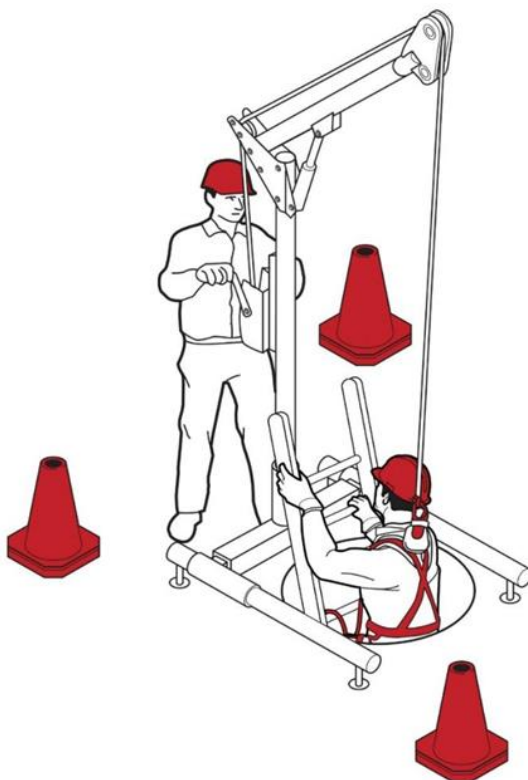
Рисунок 3 – Дежурный, контролирующий замкнутое пространство с помощью спасательного оборудования и знака на месте
