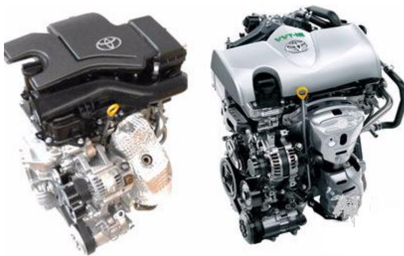
Рисунок 3.4 – Бензиновые двигатели Toyota объемами 1,0 и 1,3 литра, работающих по циклу Аткинсона
