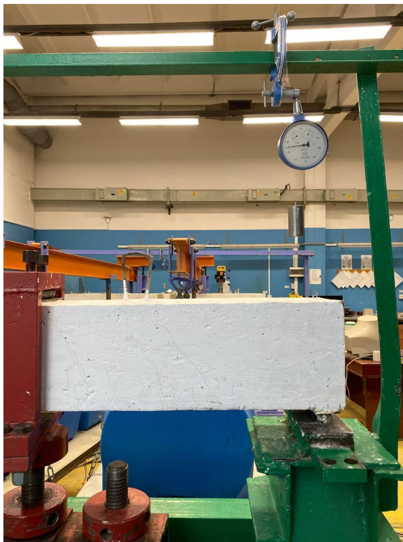
Рисунок 29 – Трещины в приопорном участке балки со сферическими пустотообразователями
