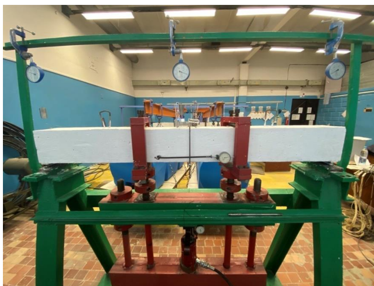
Рисунок 22 – Подготовленная к испытаниям балка со сферическими пустотообразователями
