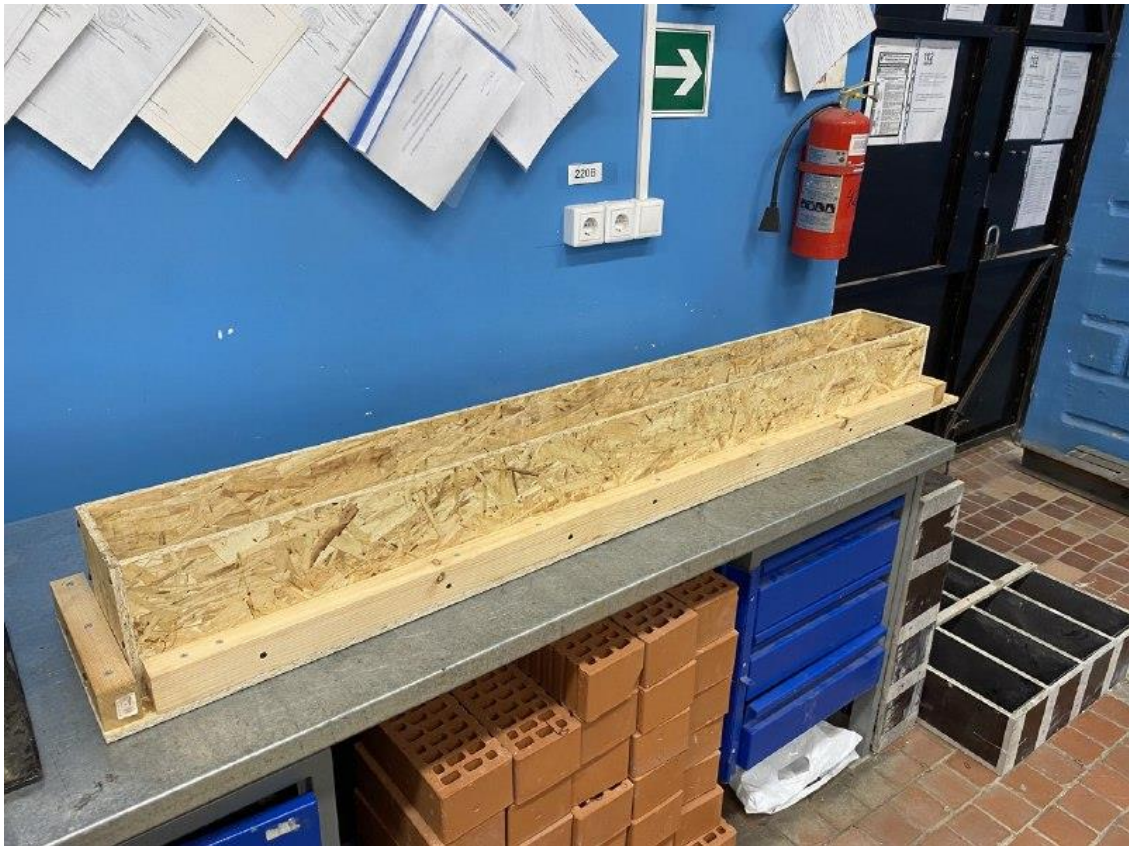
Рисунок 13 – Опалубка для изготовления образца балки
