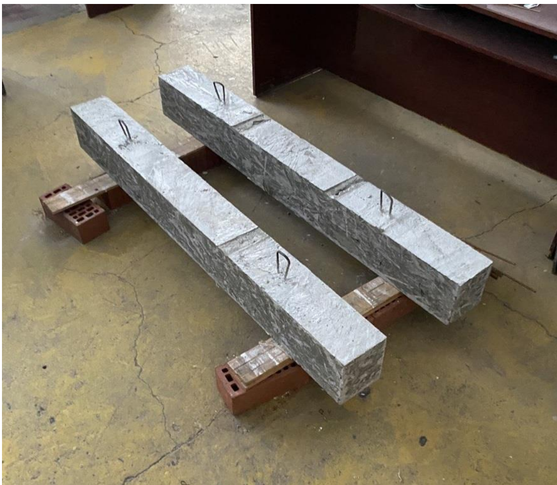
Рисунок 15 – Готовые образцы балок возрастом 7 суток
