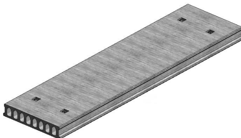
Рисунок 3 – Многопустотная железобетонная сборная плита марки ПБ
