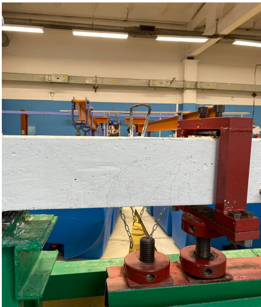
Рисунок 27 – Трещины в приопорном участке балки со сферическими пустотообразователями
