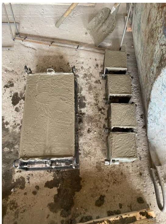
Рисунок 10 – Экспериментальные призмы с бетонными кубиками
