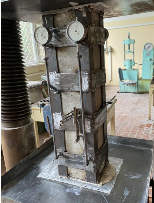
Рисунок 19 – Разрушение призмы с усилением, с внецентренным приложением нагрузки
