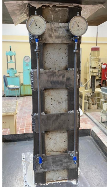
Рисунок 16 – Установка датчиков на призмах
