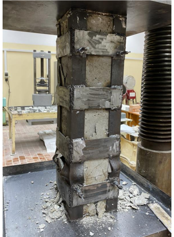
Рисунок 19 – Разрушение призмы с усилением, с внецентренным приложением нагрузки
