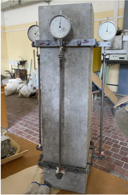
Рисунок 16 – Установка датчиков на призмах
