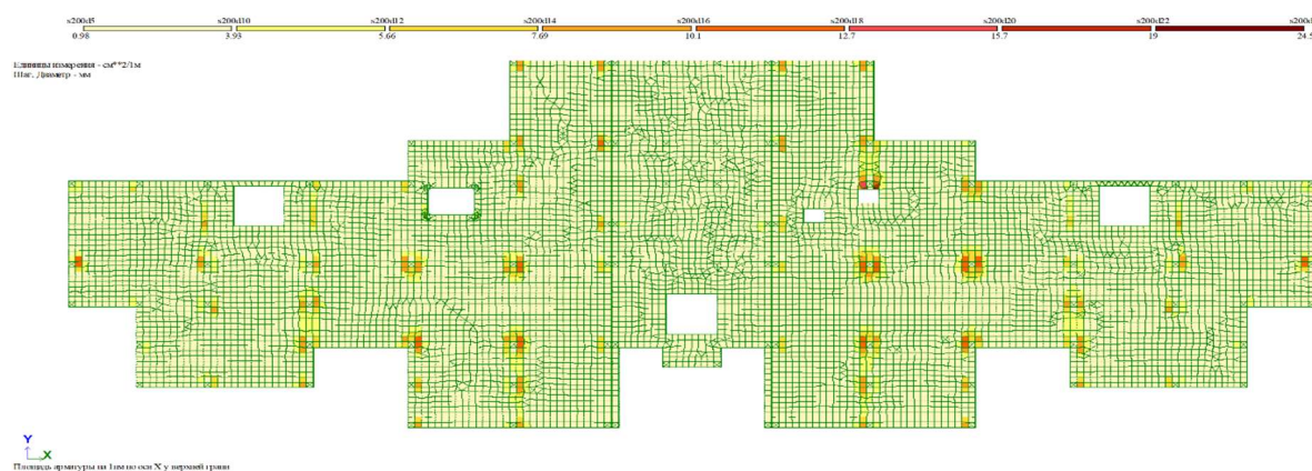
Рисунок 4 – Площадь арматуры в направлении X , в верхней зоне
