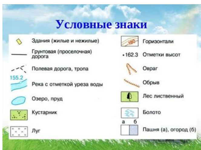
Рисунок 5 – Дополнительный материал для кейса «Обозначения на плане»
