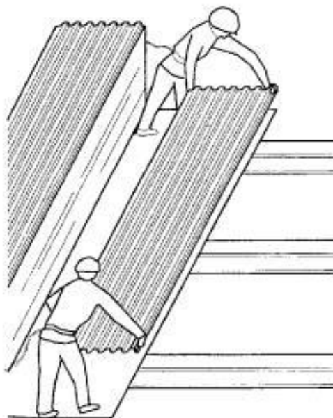
Рисунок В.3 – Раскладка стального профилированного настила
