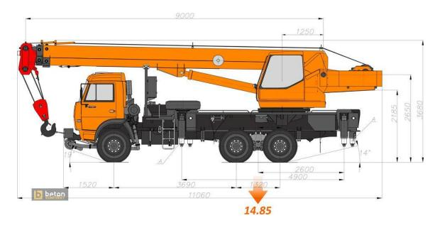
Рисунок 14 – Стреловой автомобильный кран КС-55713
