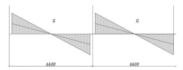
Рисунок 3 — Расчетная схема фрагмента плиты перекрытия с опирание на колонны по четырем сторонам, определение максимальных действующих поперечных сил
