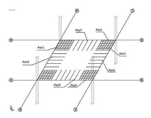
Рисунок 9 – Схема верхнего армирования плиты перекрытия
