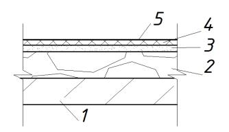
Рисунок 2 — Состав конструкции покрытия: 1 — ж/б плиты, 2- керамзитовый гравий, 3 — цем.песч. стяжка, 4 — утеплитель, 5 — кровельная ПВХ-мембрана.
