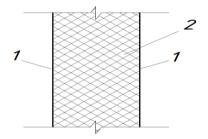
Рисунок 1 — Устройство стеновой сэндвич-панели: 1 — общивка, 2 — утеплитель.
