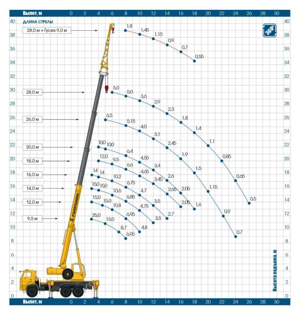
Рисунок 13 - Графика грузоподъемности с учетом требуемого вылета стрелы
