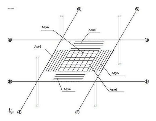
Рисунок 10 – Схема нижнего армирования плиты перекрытия
