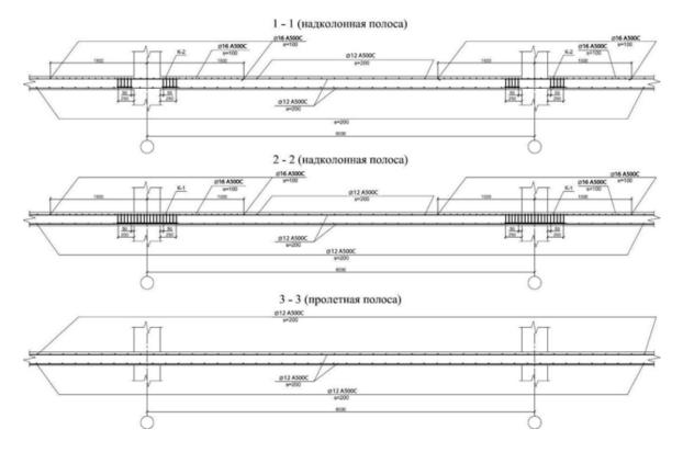
Рисунок 12 – Армирование плиты перекрытия в осях 4-5
