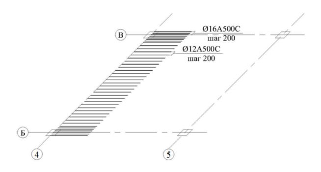
Рисунок 11 – План раскладки дополнительной арматуры на опорах
