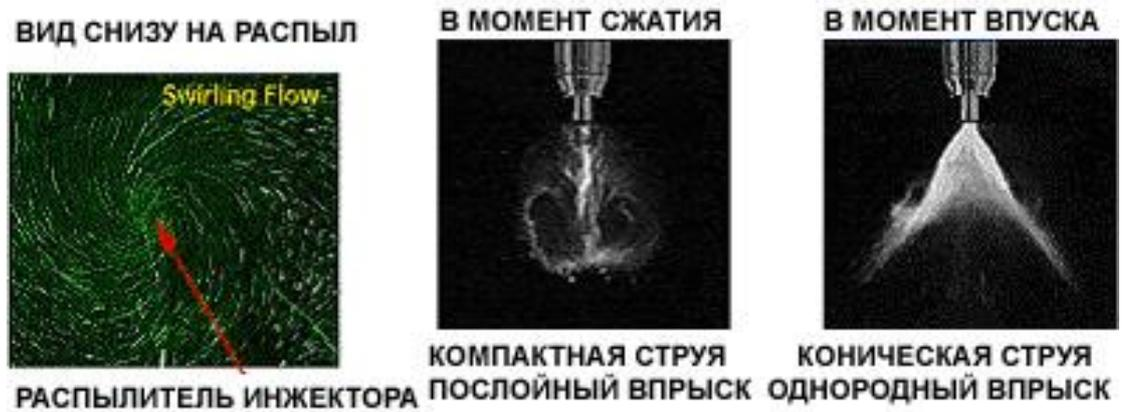
Рисунок 5.3 - Распыление топлива инжектором при непосредственном впуске топлива
