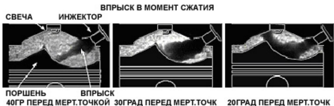
Рисунок 5.4 - Обеспечение необходимых условий распыления топлива для работы на бедной смеси
