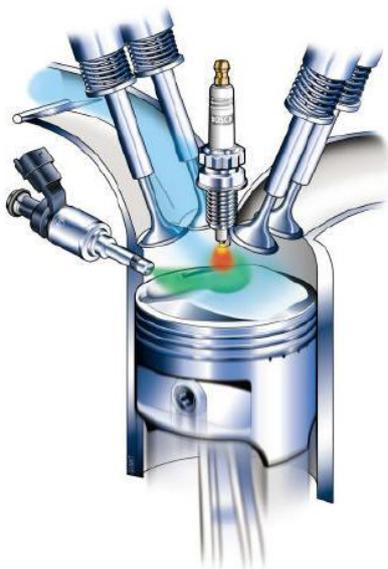
Рисунок 1.1 - Прямой впрыск топлива
