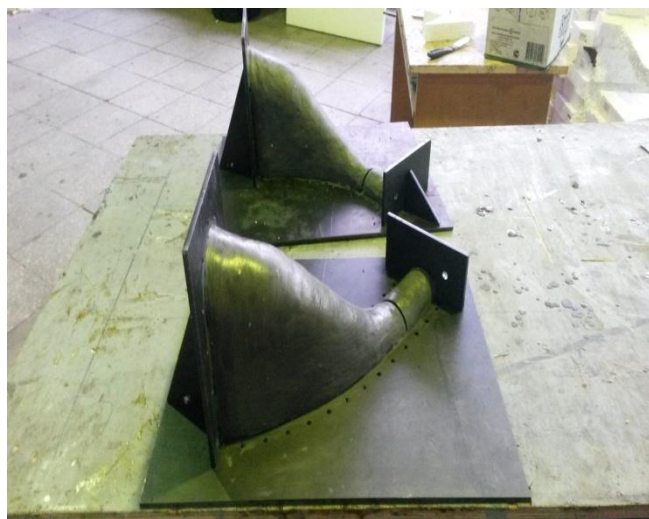
Рисунок 10 – Форма из пластилина (вид с боку)
