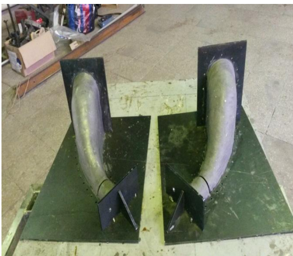
Рисунок 9 – Форма из пластилина
