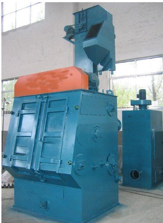
Рисунок 16 – Дробемётная установка Q-3210
