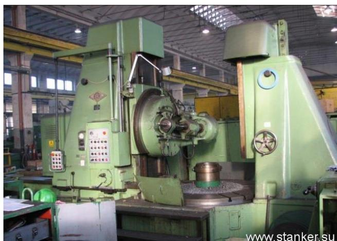
Рисунок 5 – Зубофрезеральный станок 5А342
