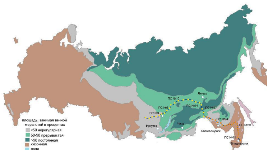
Рисунок 1 – Схема прокладки нефтепровода ВСТО через территорию с вечной мерзлотой
