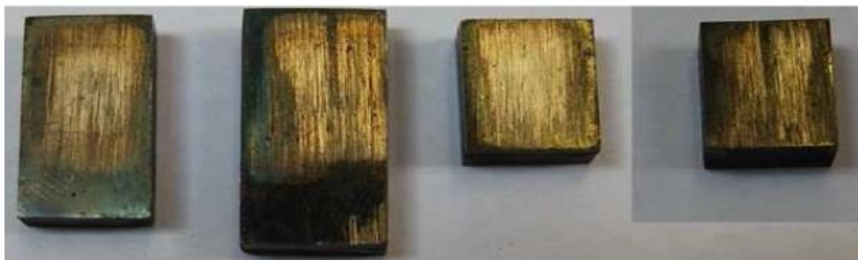
Рисунок 11 – Внешний вид наплавленных образцов после проведения испытаний на задироустойчивость
