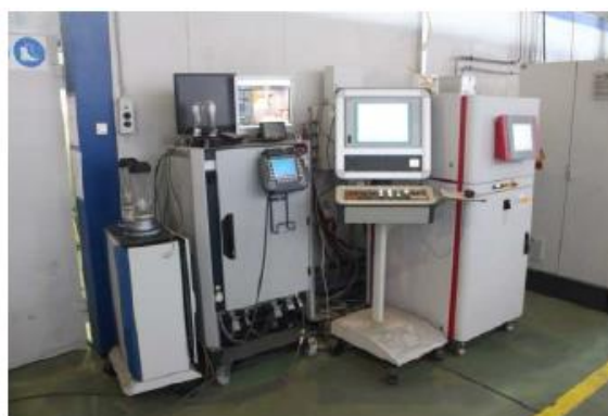
Рисунок 8 – Аппаратура управления и питания комплекса роботизированной плазменной наплавки
