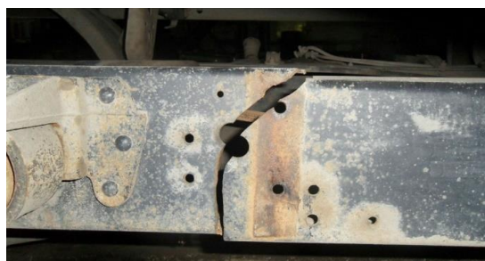
Рисунок 2 – Поперечный излом швеллера лонжерона
