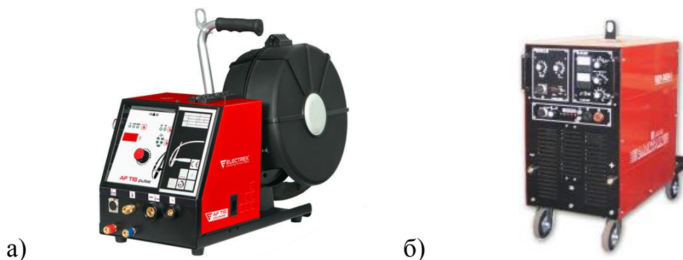
Рисунок 17 – Применяемое сварочное оборудование: механизм подачи МПК-4-2 (а) и выпрямитель ВДУ-3020 (б)
