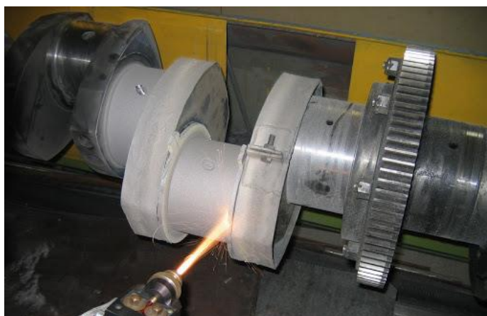
Рисунок 17 – Плазменное нанесение покрытия при восстановлении вала
