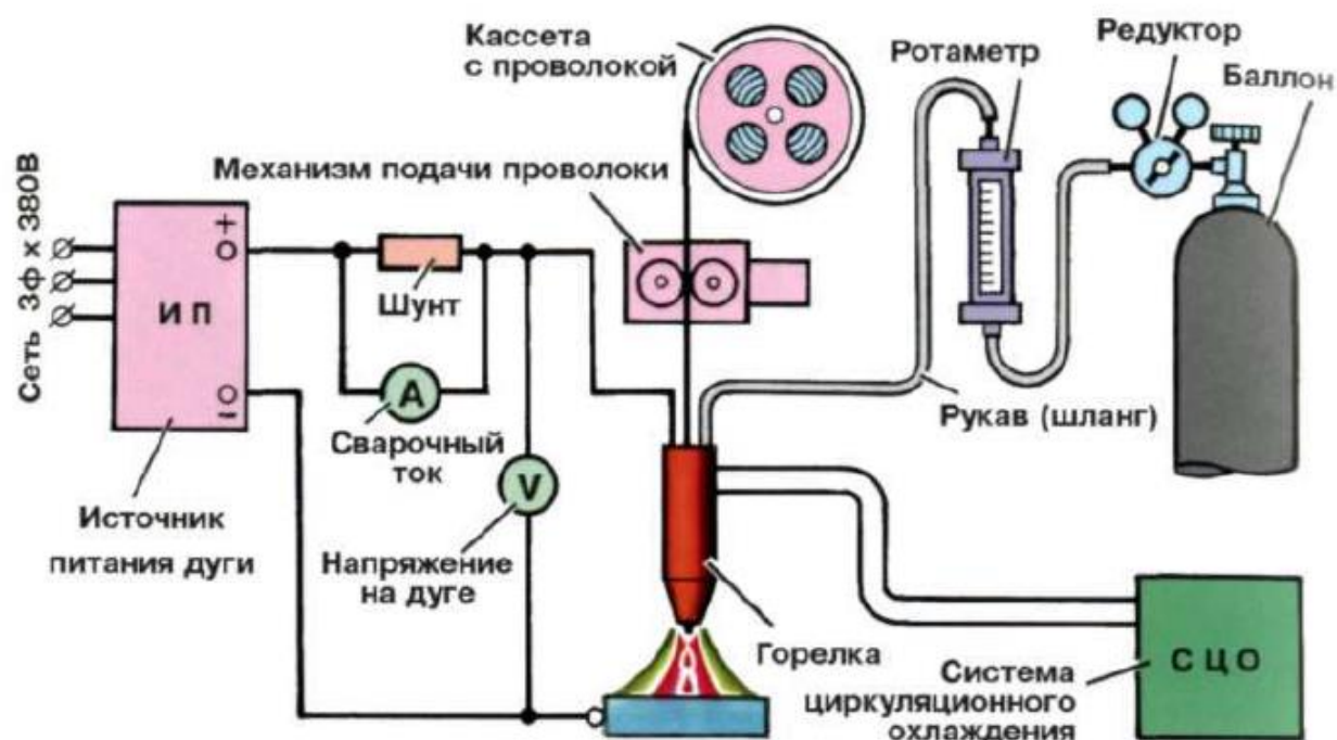
Рисунок 11 – Схема выполнения сварки плавящимся электродом в защитных газах
