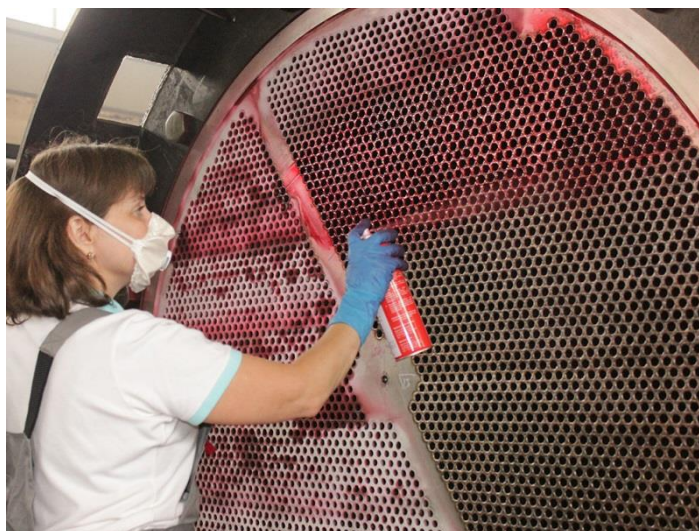
Рисунок 18 – Проведение цветной дефектоскопии при контроле качества соединения «труба-трубная доска»
