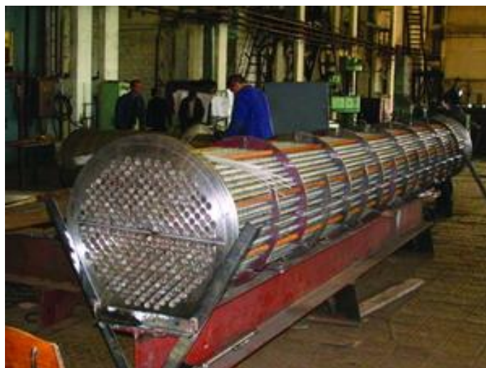
Рисунок 16 – Установка труб в трубных досках
