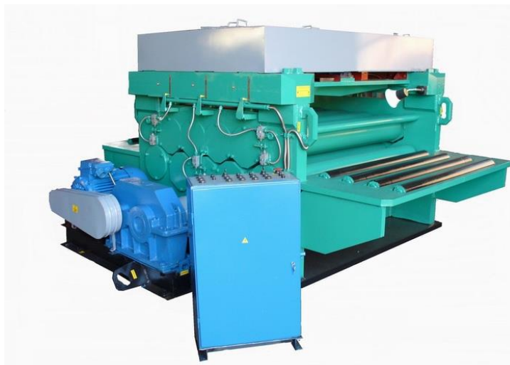
Рисунок 15 – Машина для правки трубных досок МЛЧ-1725
