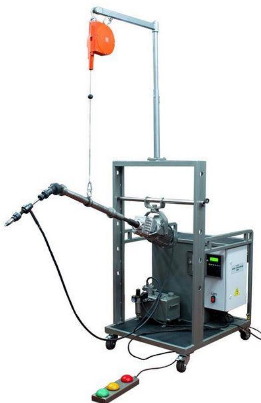
Рисунок 6 – Специальная вальцовочная машина с электрическим приводом
