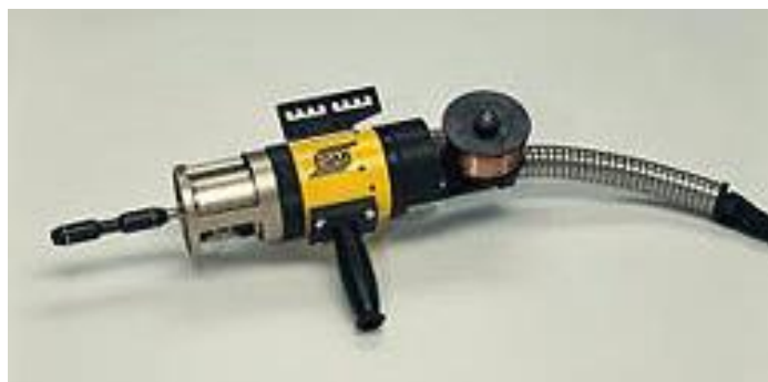
Рисунок 10 – Сварочная головка РОС 12-60 (а) и TIGTRONIC RBK (б)
