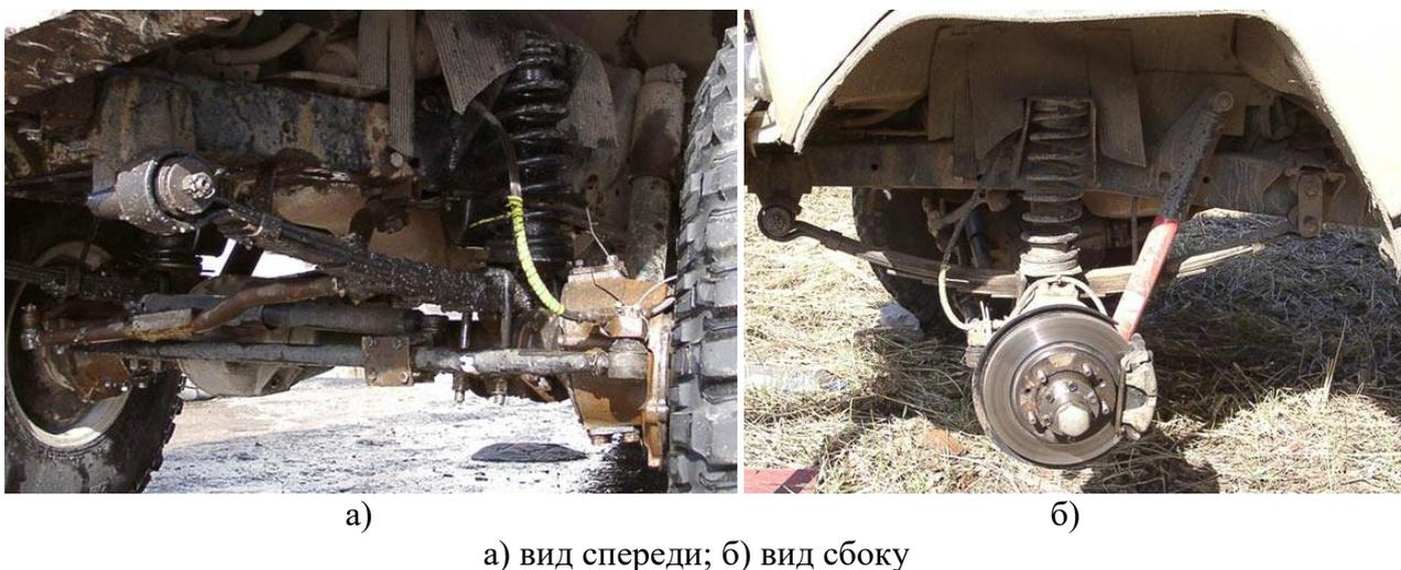
Рисунок 3 – Пример комбинированной подвески автомобиля УАЗ-31519
