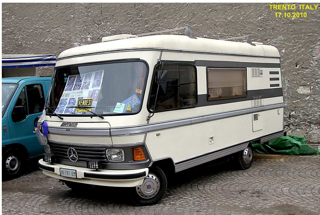
Рисунок 7 – Кэмпervан с грузовой крышей «high top» на шасси микро-автобуса Mercedes-Benz
