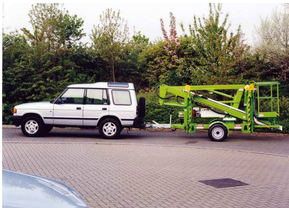
Рисунок 10 – Мини прицепной подъемник с телескопической стрелой.
