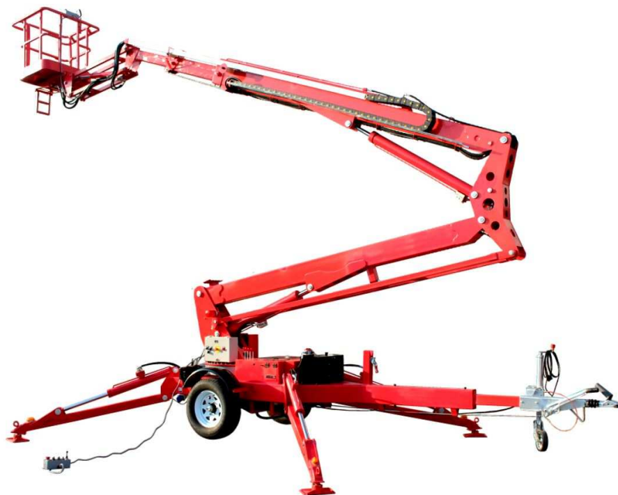
Рисунок 10 – Мини прицепной подъемник с телескопической стрелой.
