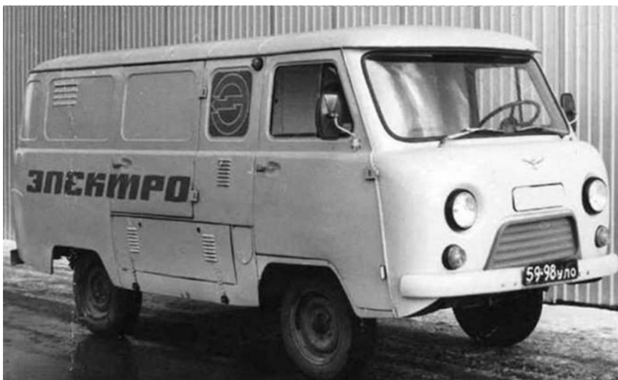
Рисунок 6 – Электромобиль У-131 на базе автомобиля УАЗ-451
