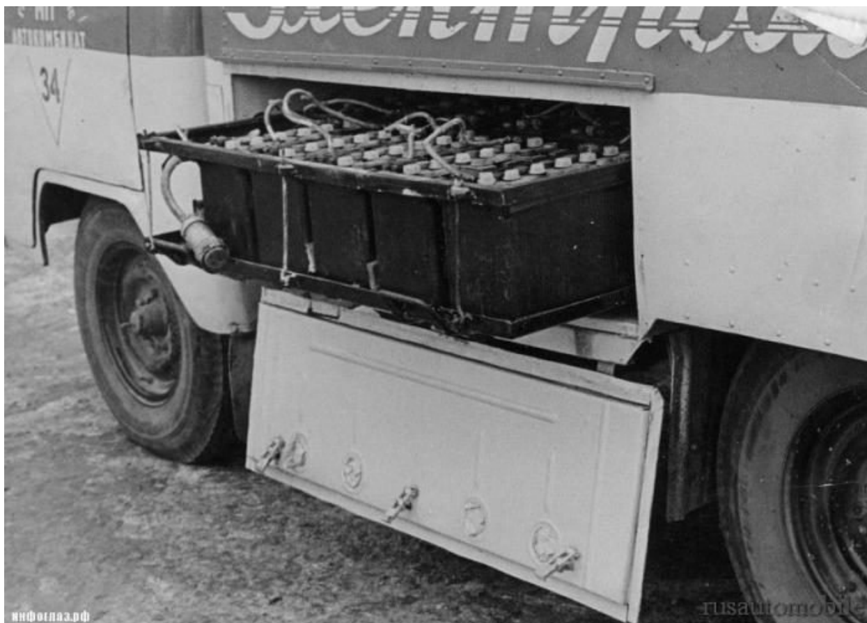
Рисунок 7 – Аккумуляторный отсек электромобиля У-131
