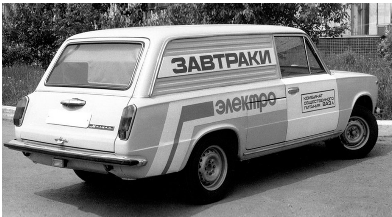
Рисунок 5 – Электромобиль на базе автомобиля ВАЗ-2102
