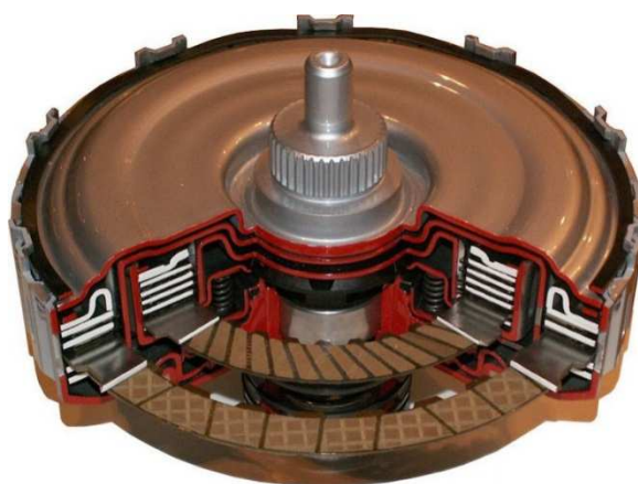
Рисунок 4 - Сцепление с мокрым типом двойное
