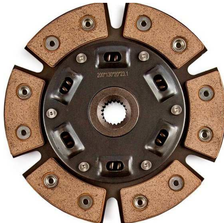
Рисунок 7 - Сцепление диска с керамической фрикционной накладкой
