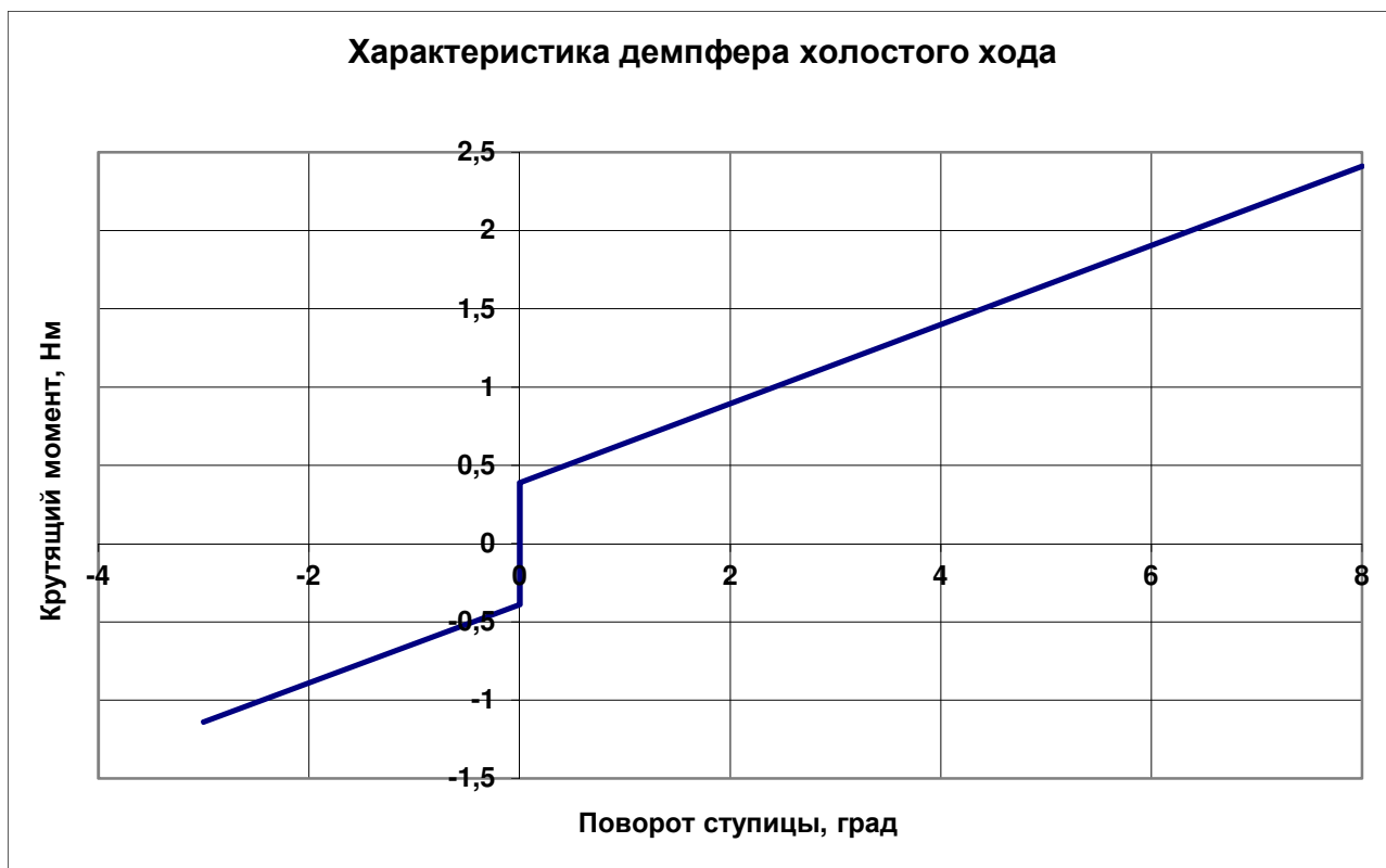
Рисунок 8 - Характеристика демпфера холостого хода.
