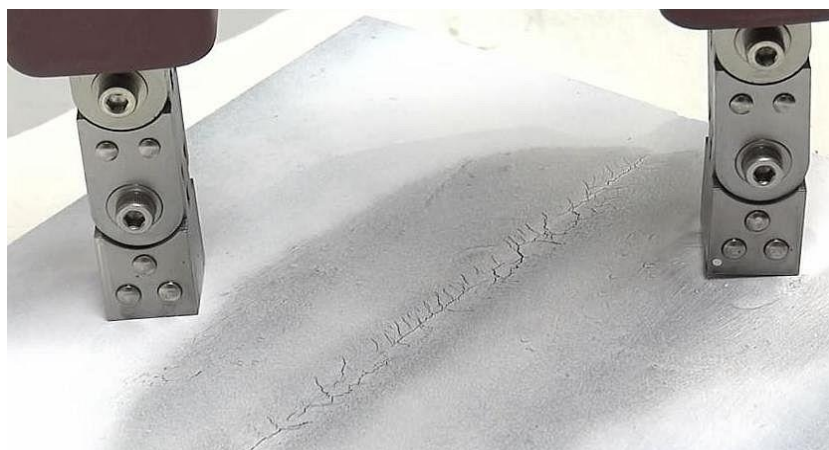
Рисунок 16 – Скопление частиц магнитного порошка в зоне расположения дефекта
