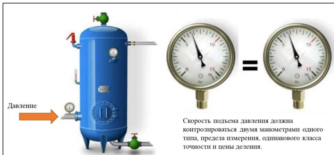
Рисунок 20 – Гидравлическое испытание сосуда, работающего под давлением
