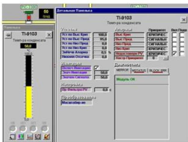
Рисунок 11 – Детальная панелька модуля аналогового сигнала.
