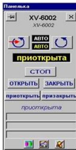
Рисунок 20 – Стандартная панелька управления электродвигателем задвижки
