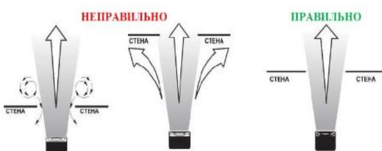
Рисунок 8 – Схема правильного расположения вентилятора при дымоудалении в помещении [42]
