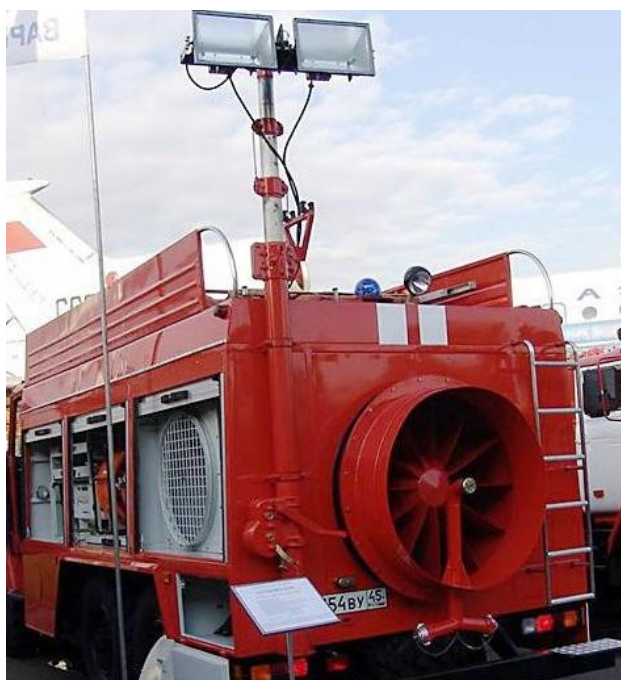
Рисунок 4 – Вентилятор (эжектор), использующийся при тактической вентиляции [41]
