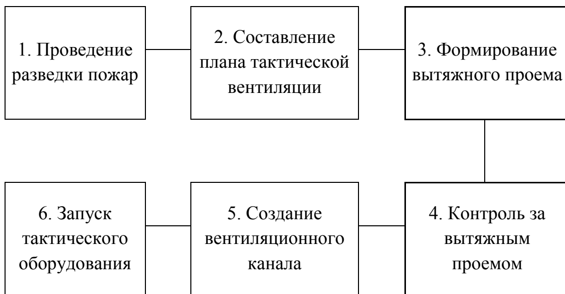
Рисунок 7 – Порядок проведения тактической вентиляции [20]
