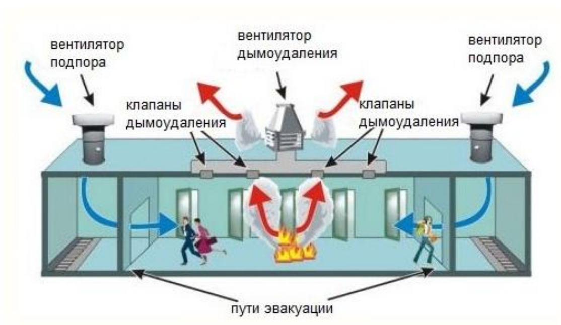
Рисунок 1 – Принцип работы системы дымоудаления
