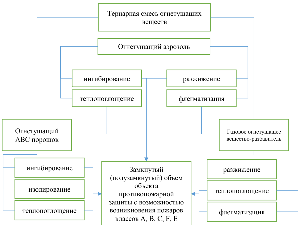
Рисунок 2 – Комбинированное влияние факторов на процессы прекращения горения в замкнутом (полузамкнутом) объеме с возможностью возникновения пожаров классов А, В, С, F и Е во время тушения тернарной смесью огнетушащих веществ объемным способом
