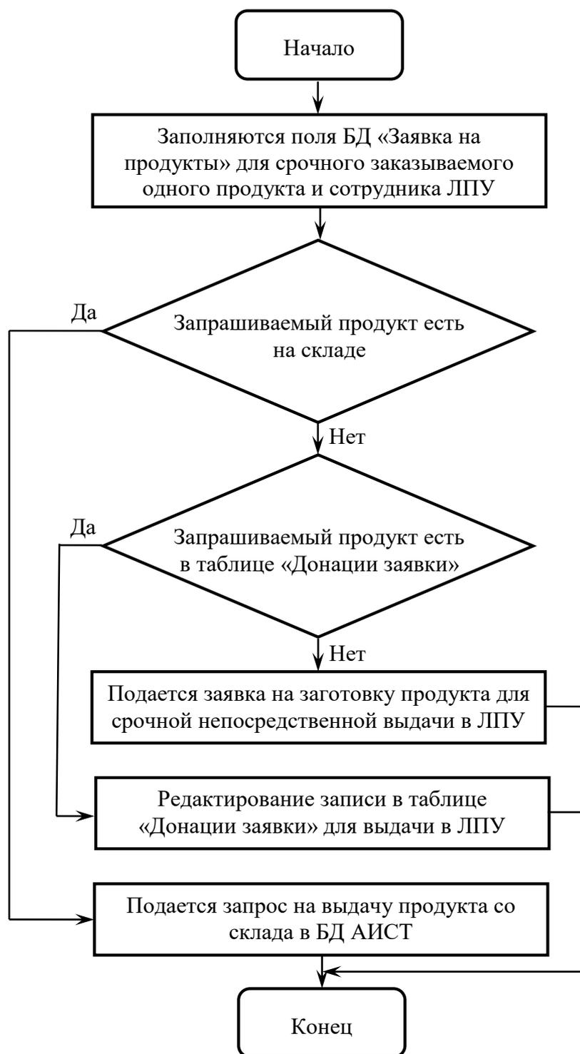
Рисунок 12 – Алгоритм заявки ЛПУ на продукт
