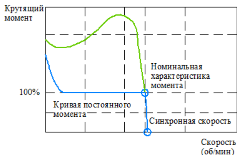
Рисунок 10 – Зависимость крутящего момента от скорости вращения (постоянный момент)
