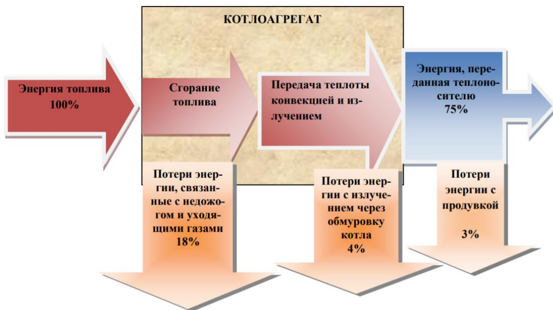
Рисунок 3 – Виды потерь в котельной
