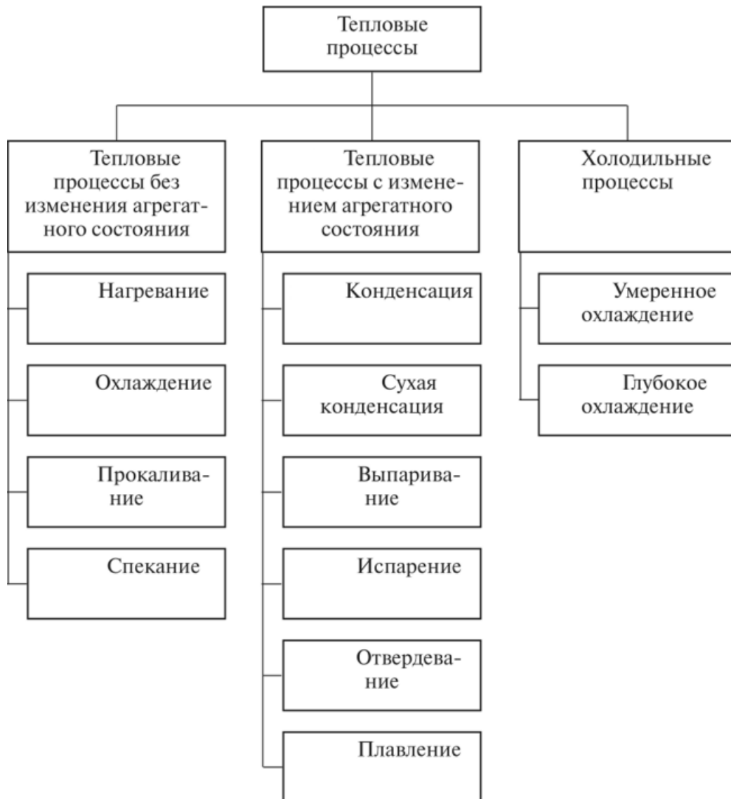
Рисунок 6 – Классификация тепловых процессов протекающих на химическом предприятии
