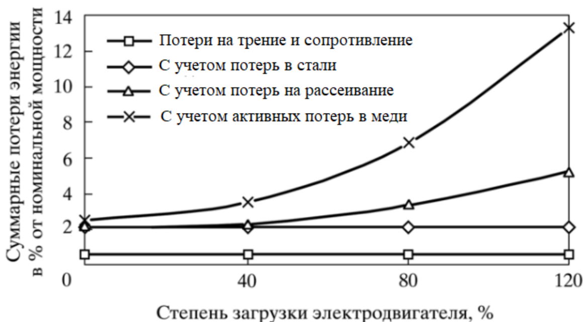
Рисунок 18 – Сложение потерь мощности в электрических двигателях
