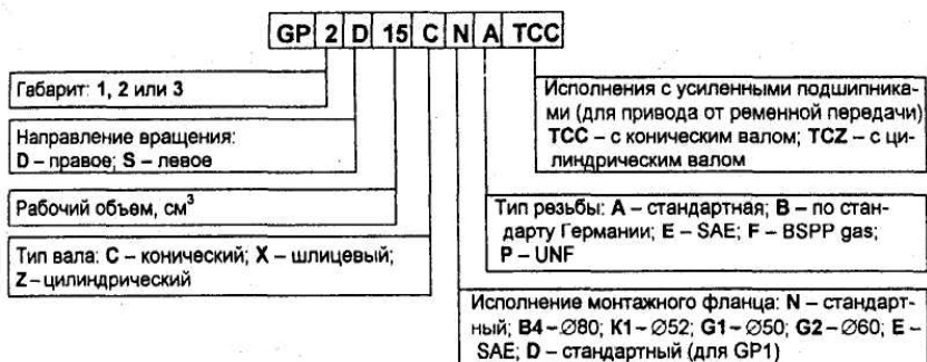
Рис. 3.1. Условное обозначение насоса
