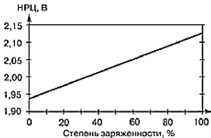
Рисунок 1.10 - Зависимость напряжения разомкнутой цепи от степени заряженности
