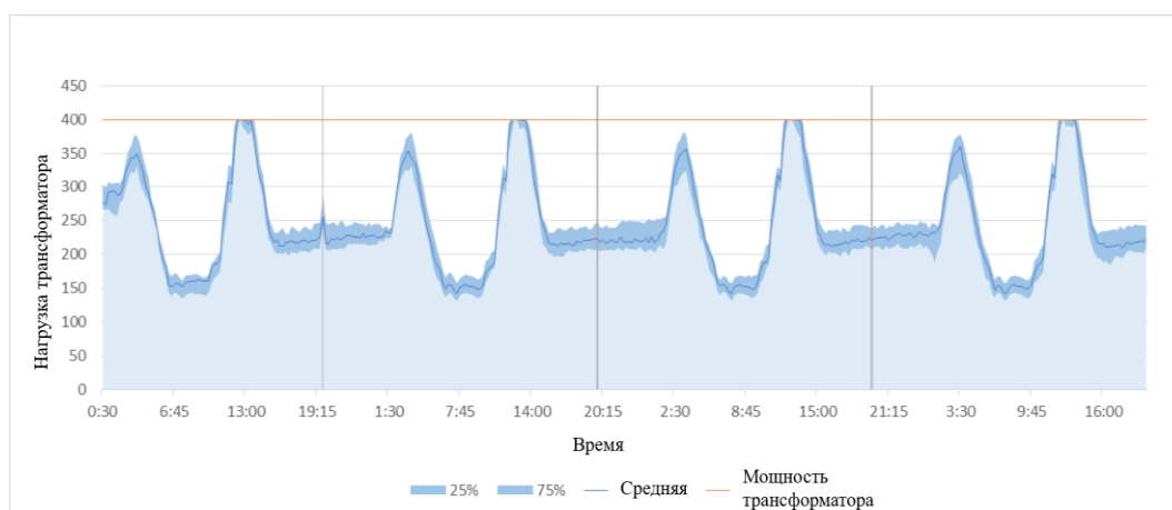
Рисунок 25 – Профиль нагрузки трансформатора 5 в эксперименте «Транспортное средство-сеть» в течение четырех дней
