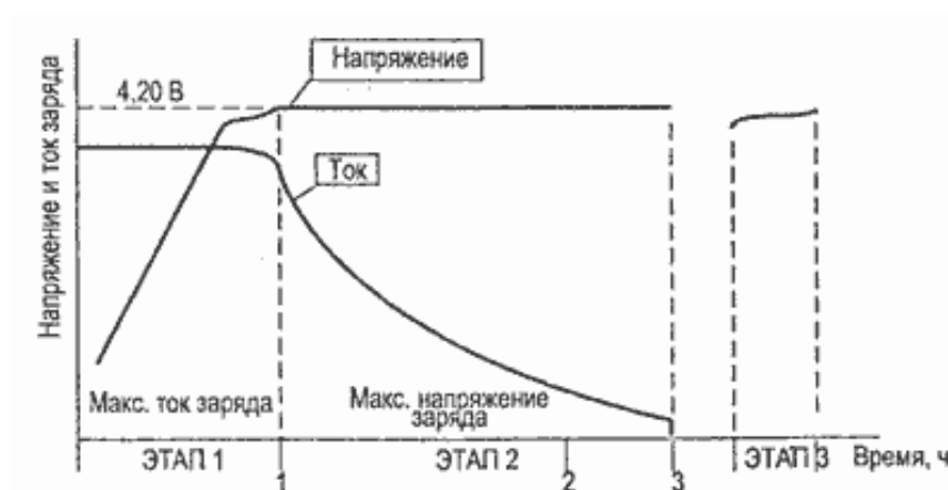
Рисунок 3. Зависимость напряжения и тока от времени при заряде Li-ion аккумулятора
