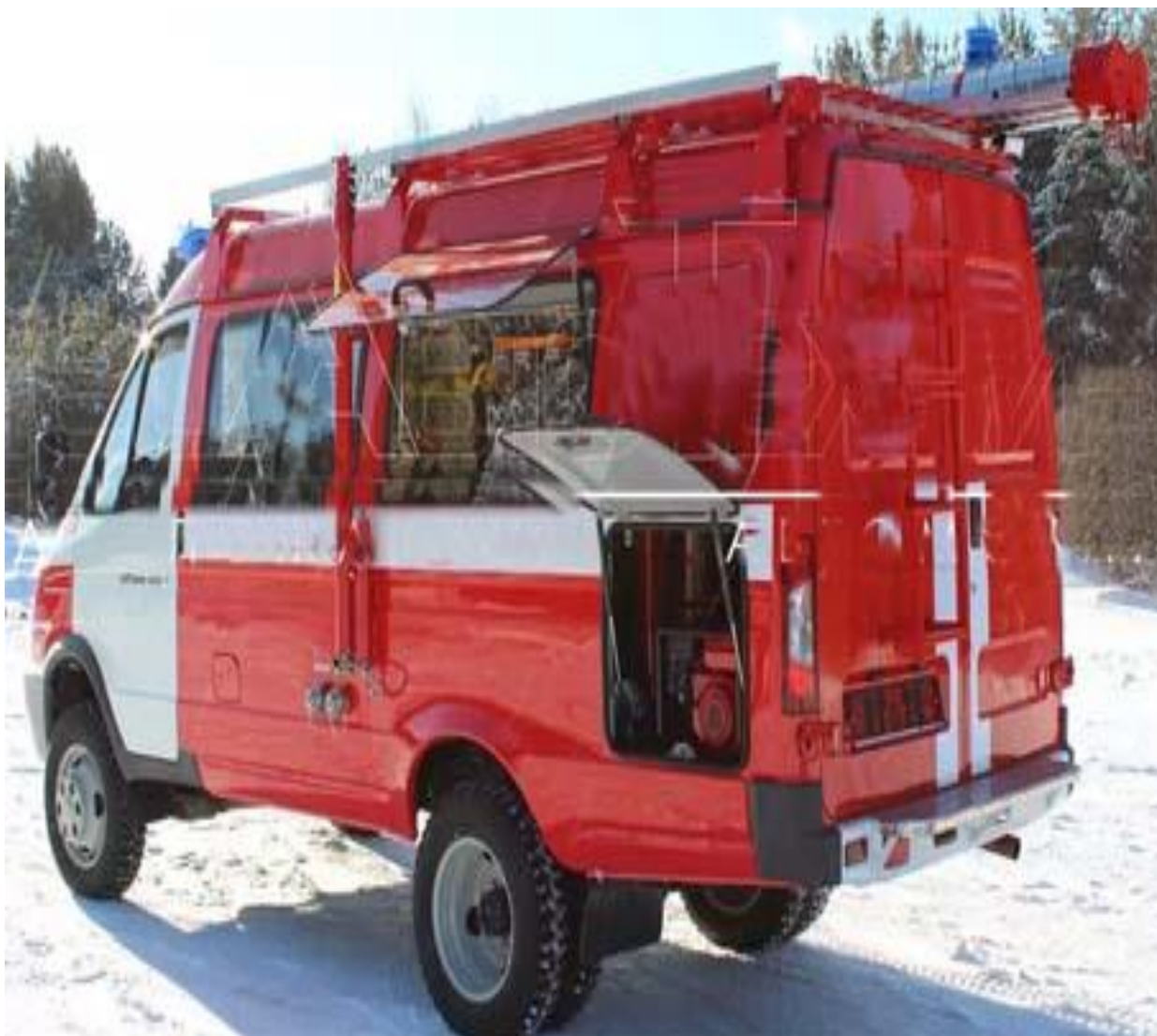
Рисунок 10 – Многофункциональный автомобиль первой помощи с системой NATISK на базе ГАЗ АПП-0,3-2,0-NATISK (27057)
