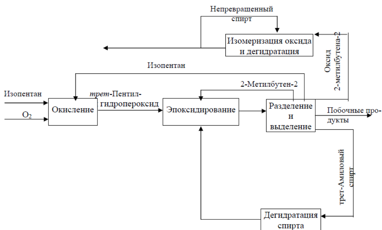
Рисунок 1 – Получение изопрена жидкофазным окислением изопентана
