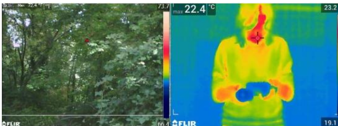
Рисунок 20 – Результат съемки при наведении тепловизора на стекло
