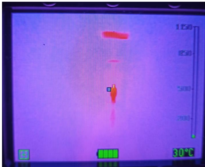
Рисунок 22 – Качество съёмки тепловизором «ПИТОН» с расстояния 15 метров
