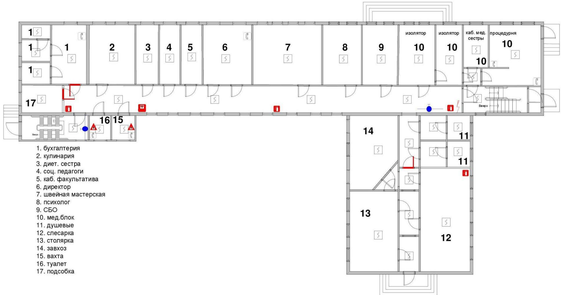
Рисунок Б.7 – План расстановки пожарных мультисенсорных извещателей первого этажа
